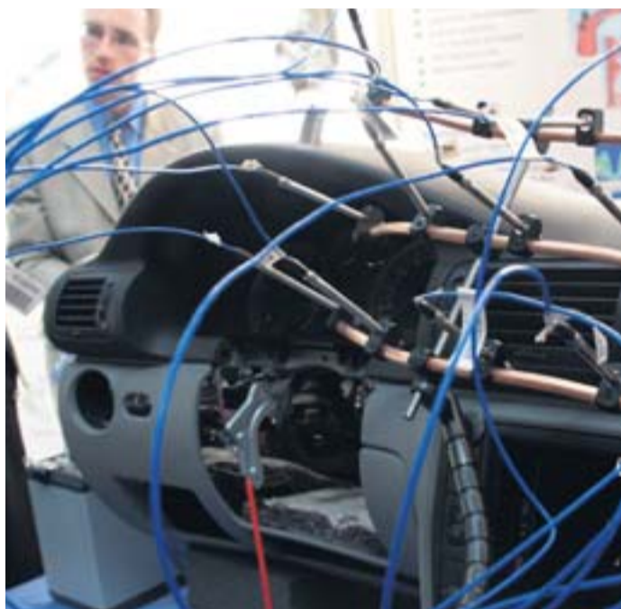
Visualisierte Schlüsseltechnologie: Aktive Systeme der Wölfel Beratende Ingenieure GmbH zur aktiven Schwingungsminderung (unten) sind auch in diesem Jahr in der Lokhalle zu sehen.
